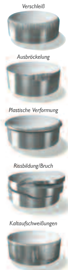
Die häufigsten Ausfallmechanismen bei Kaltarbeitswerkzeugen.
