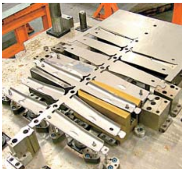
Bild 1 Umformen eines Verstärkungsteils für B-Träger aus 2 mm dickem Docol DP 800
