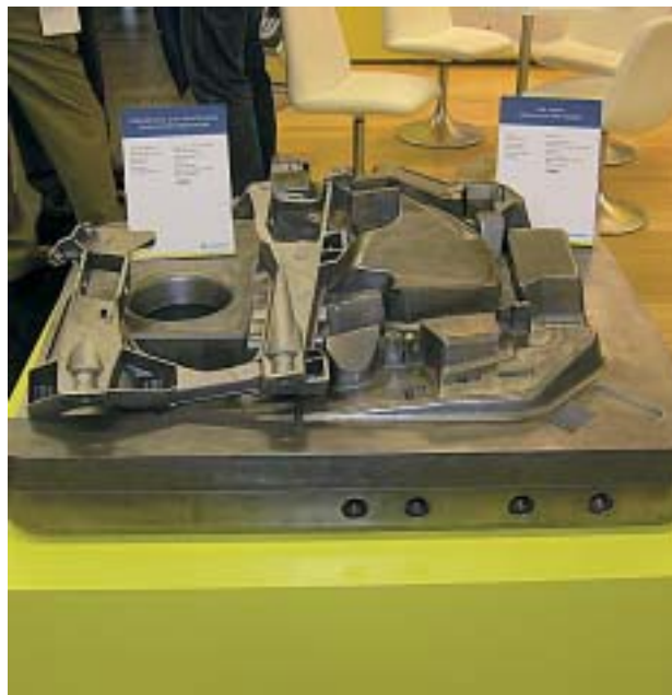
Der von der Firma BDW technologies GmbH zur Verfügung gestellte Formeinsatz aus Uddeholm Dievar lockte zahlreiche Besucher auf den Messestand
