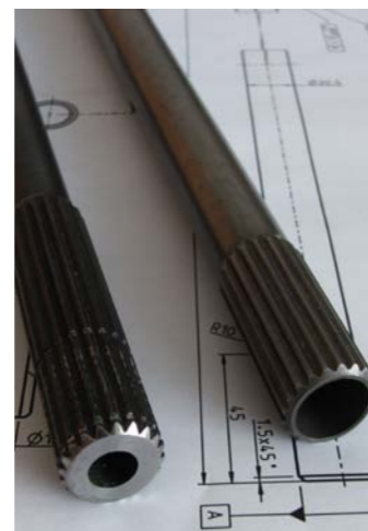
1. Die neue Antriebswelle aus Uddeholm Orvar Supreme (rechts) neben der bisher verwendeten Antriebswelle (links)
