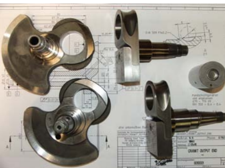
2. „Gebaute“ Kurbelwelle aus Nimax mit Wolframstahlausgleichmassen und Hubzapfen (rechts) neben der originalen Kurbelwelle von KTM (links)
