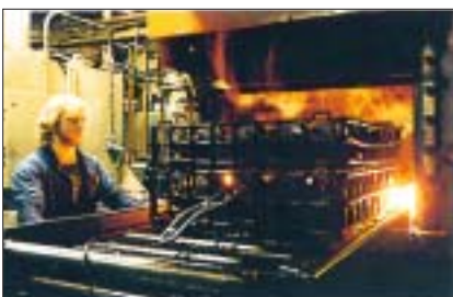
Kammerofen mit geregelter Atmosphäre
