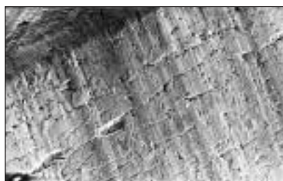
Foto 2. REM-Aufnahme eines Stempels aus W.-Nr. 1.2379, der durch adhäsiven Verschleiß abgenutzt wurde (Werkstückstoff austenitischer, rostfreier Stahl).
