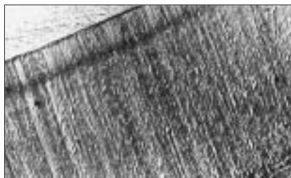
Foto 1. REM-Aufnahme eines Stempels aus W.-Nr. 1.2379, der durch abrasiven Verschleiß abgenutzt wurde (Werkstückstoff 1%iger C-Stahl bei 46 HRC).
