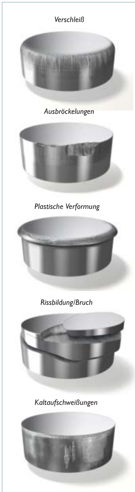
Abbildung 3. Die häufigsten Ausfallmechanismen bei Kaltarbeitswerkzeugen.
