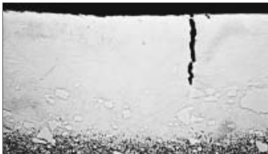
Foto 4. Oberfläche von Uddeholm Sverker 21 nach dem Senkerodieren mit einer hohen Stromstärke. Die „weiße Schicht“ ist spröde und enthält Risse.
